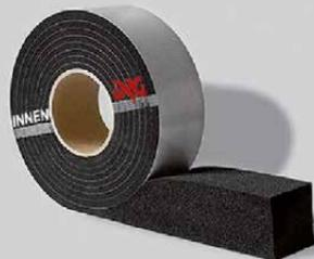
Das DRG-Multiband 3D ist ein neues speziell imprägniertes vorkomprimiertes Multifunktionsband zur Luft- und Schlagregenabdichtung sowie Dämmung von der Fensterbewegungsfugen. Spezielle Zonen im Band mit unterschiedlichen Raumgewichten sorgen für die Abdichtung nach dem Prinzip „innen dichter als außen“.
