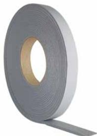
Das Fugendichtband BG2 mit 300 Pa DIN 18542 ist ein Fugendichtungsband aus imprägniertem Schaumstoff. Es dient zur äußeren und inneren Abdichtung von Fugen und Anschlüssen im Fensterbau, sowie im gesamten Hochbau gegen Schlagregen bis 450 Pa.
